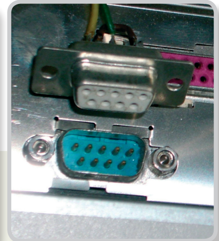
Слика 3.34. – ПРЕНОС ПОДАТАКА ПРЕКО СЕРИСКОГ ПОРТА а) пример слања декадног броја 125 у бинарном коду, б) изглед конектора за серијски порт
