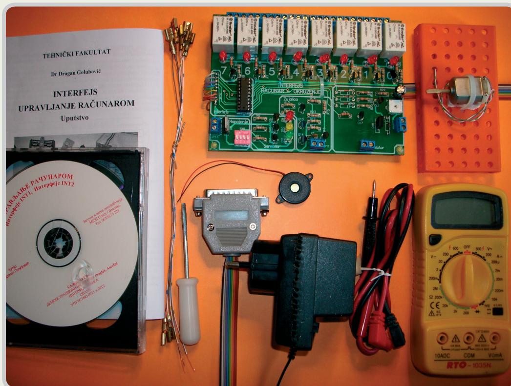
Слика 3.39. - ЕЛЕКТРОНСКО ИНФОРМАТИЧКИ НАСТАВНИ СИСТЕМ ИНТЕРФЕЈС: а) прикључен на рачунар, б) састав ИНТ1 - електронска плоча, микројотор, зујалица, везни проводници, одвртка, универзални електро инструменти, CD са програмима и упућством, извор за напајање
